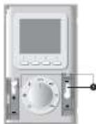
Befestigen Sie den Thermostat mit Schrauben und Dübeln in der Wand bzw. auf einem Einbaugehäuse (Achsabstand 60 mm). Legen Sie die Batterien mit korrekter Polung (Einlegerichtung) wieder ein.
