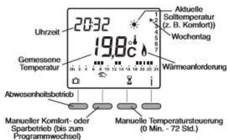
Bei Inbetriebnahme wird die vom Thermostat gemessene Temperatur angezeigt (das Zeichen erscheint über °C). Drücken Sie die Taste i, um die Solltemperatur anzuzeigen.
