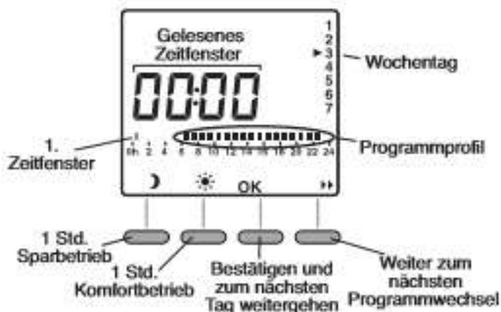
**Schnellprogrammierung:** Wenn das gleiche Programm am nächsten Tag laufen soll, halten Sie die Taste OK ca. 3 Sek. lang gedrückt, bis das Programm des nächsten Tages angezeigt wird.
