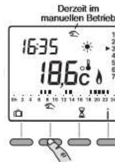
**(🕒)** **Für eine einstellbare Dauer von 30 bis 72 Std.** Bei dieser Betriebsart kann eine Solltemperatur für eine bestimmte Dauer eingestellt werden.
