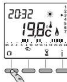
Drücken Sie auf + oder -, um die Anzahl der Tage einzustellen. Beispiel: Bei Abreise am 10. Januar und Rückkehr am 19. Januar geben Sie 9 Tage ein. Am 19. Januar schaltet die Anlage um 00:00 Uhr wieder in den Automatikmodus. Bestätigen Sie mit OK. Die Temperaturanzeige blinkt. Drücken Sie auf + oder -, um die Temperatur einzustellen. Bestätigen Sie mit OK. Um den Abwesenheitsbetrieb abubrechen (z. B. bei vorzeitiger Rückkehr), drücken Sie die Taste C oder drehen Sie den Wahlschalter.
