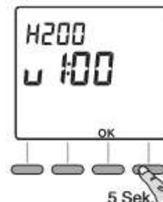
**CF01** - Berichtigung der gemessenen Raumtemperatur Falls die (per Thermometer) gemessene Temperatur von der vom Gerät gemessenen und angezeigten Raumtemperatur abweicht, kann die Fühlermessung über dieses Menü zum Ausgleich geändert werden (von -4 °C auf +4°C in 0,1 °C-Schritten).
