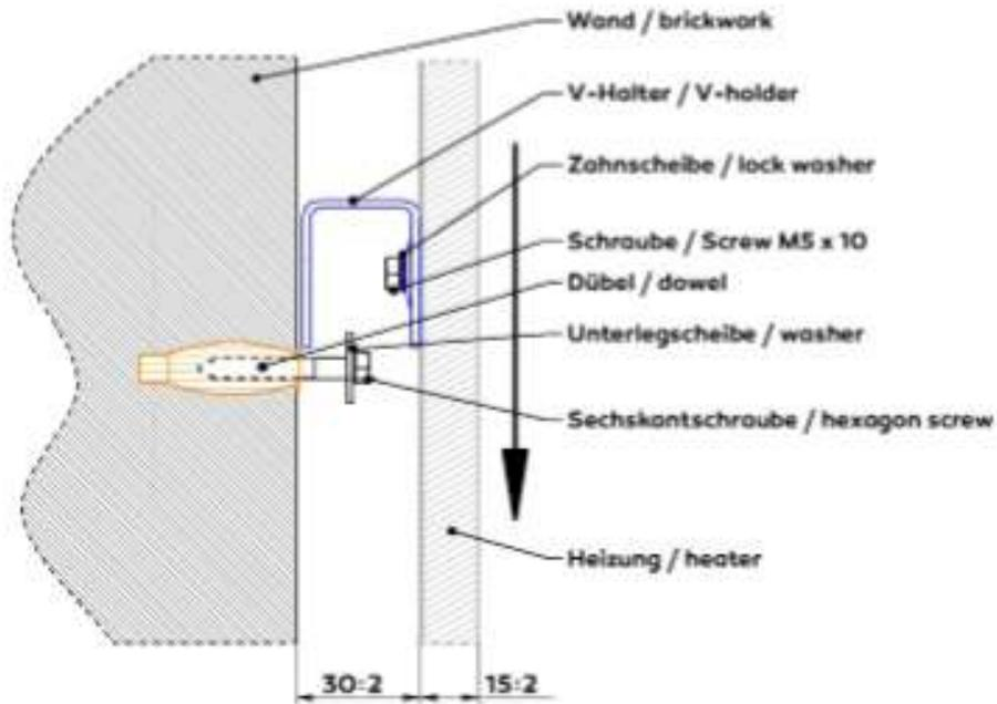
Die äußeren beiden, unteren Halter um 90° / - 90° verdrehen, dadurch wird die Heizung arretiert (siehe Skizze unten).
