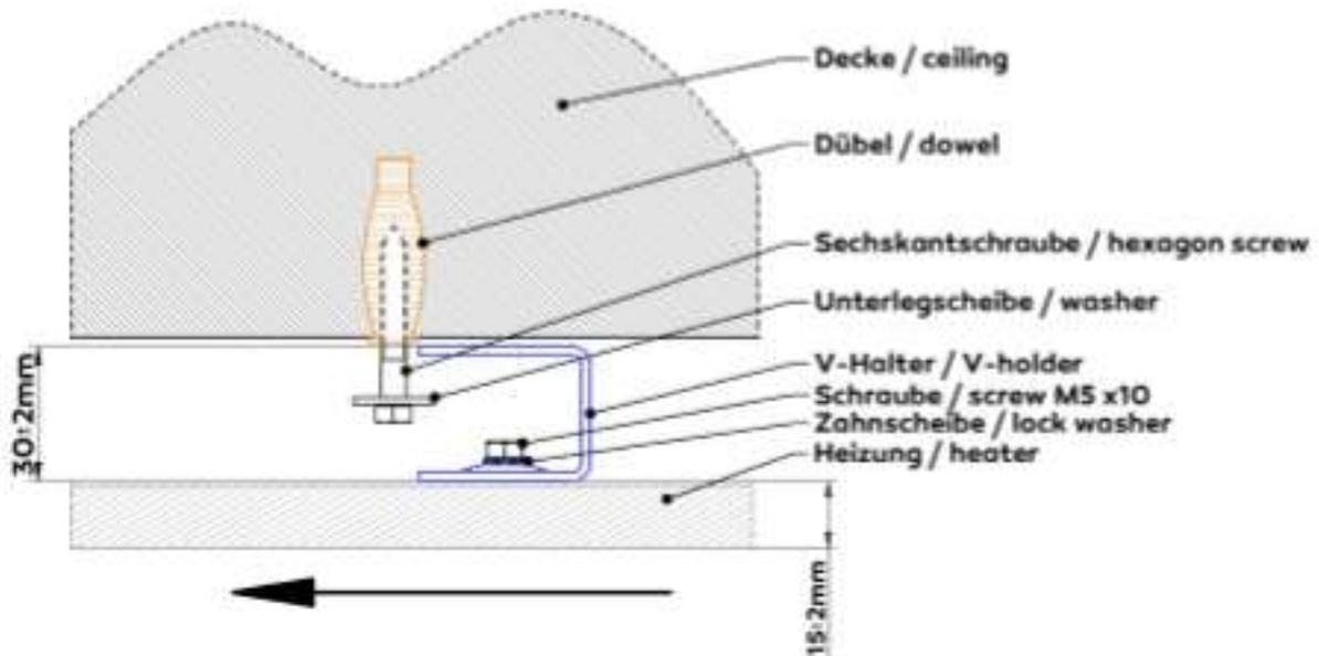
Die Halter um 90° / -90° oder um 180° / -180° verdrehen, dadurch wird die Heizung arretiert.
